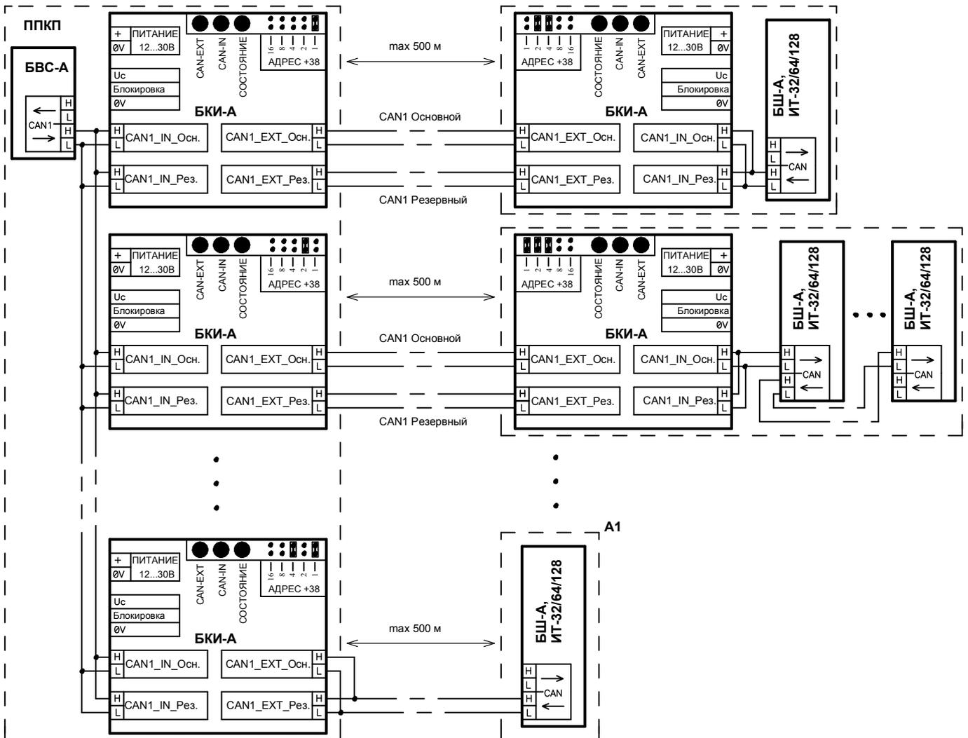
При дубле линии связи CAN1 рекомендуется основную и резервную линии связи вести разными путями. В случае ведения основной и резервной линий связи CAN1 в одном кабеле, теряется практический смысл и надежность дублирования линии связи.
