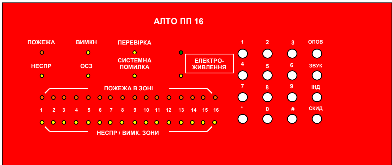
Малюнок 7. Розташування кнопок та індикаторів на панелі управління приладу АЛТО ПП 16.
